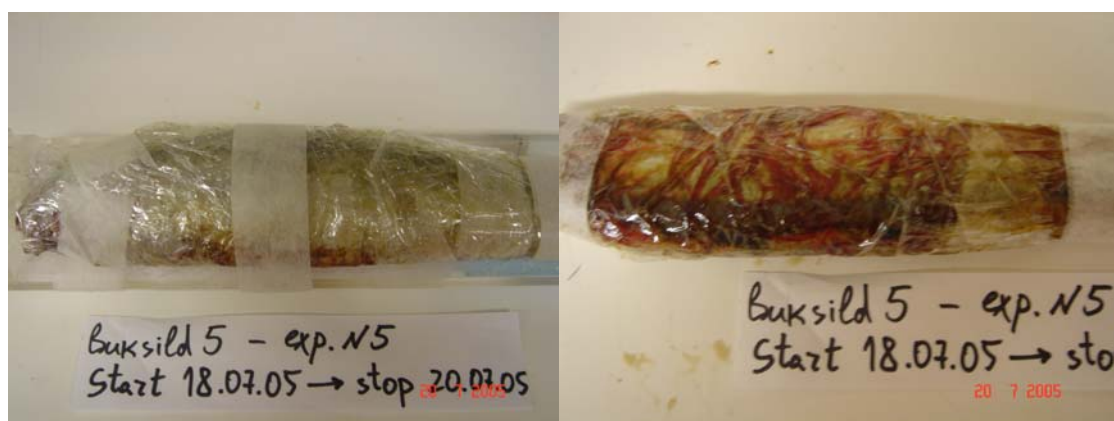
Figur 10. Fisken tatt ut av magneten etter tidsserie ble (Forsøk 2) fotografert uten å fjerne innpakningen fra toppen (venstre bilde) og fra undersiden. Betydelige mengder av væske har trukket ut av fisken og samlet seg på undersiden mellom fisk og pakning (bildet til høyre).
